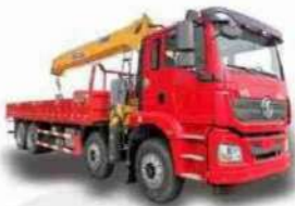
Camión con grúa montada
