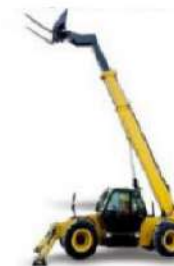
Altura máxima de elevación del telemanejador: 7-18 m
