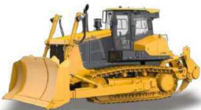
Peso de operación del bulldozer: 17 - 36 toneladas Potencia nominal: 140 - 280 kW
